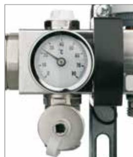
Im Vor- und Rücklauf jedes Verteilerbalkens befindet sich die Funktionsgruppe, die aus je einem integrierten Thermometer (Anzeige 0-80°C), einem Füll- und Entleerungshahn sowie einem automatischen Entlüfter besteht. Die Funktionsgruppe macht die Betriebstemperaturen und Spreizung ablesbar.
